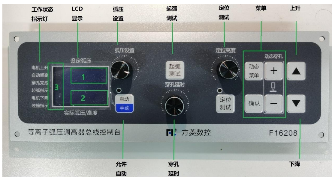
图 2.2 F16208 总线控制台面板及按键说明
