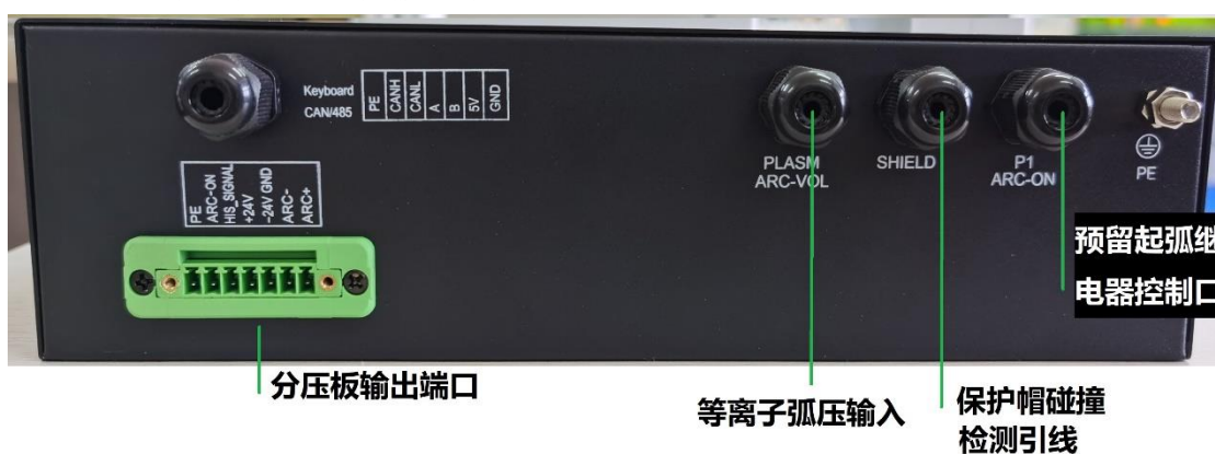
图 2.9 分压板输出端口接线示意图
