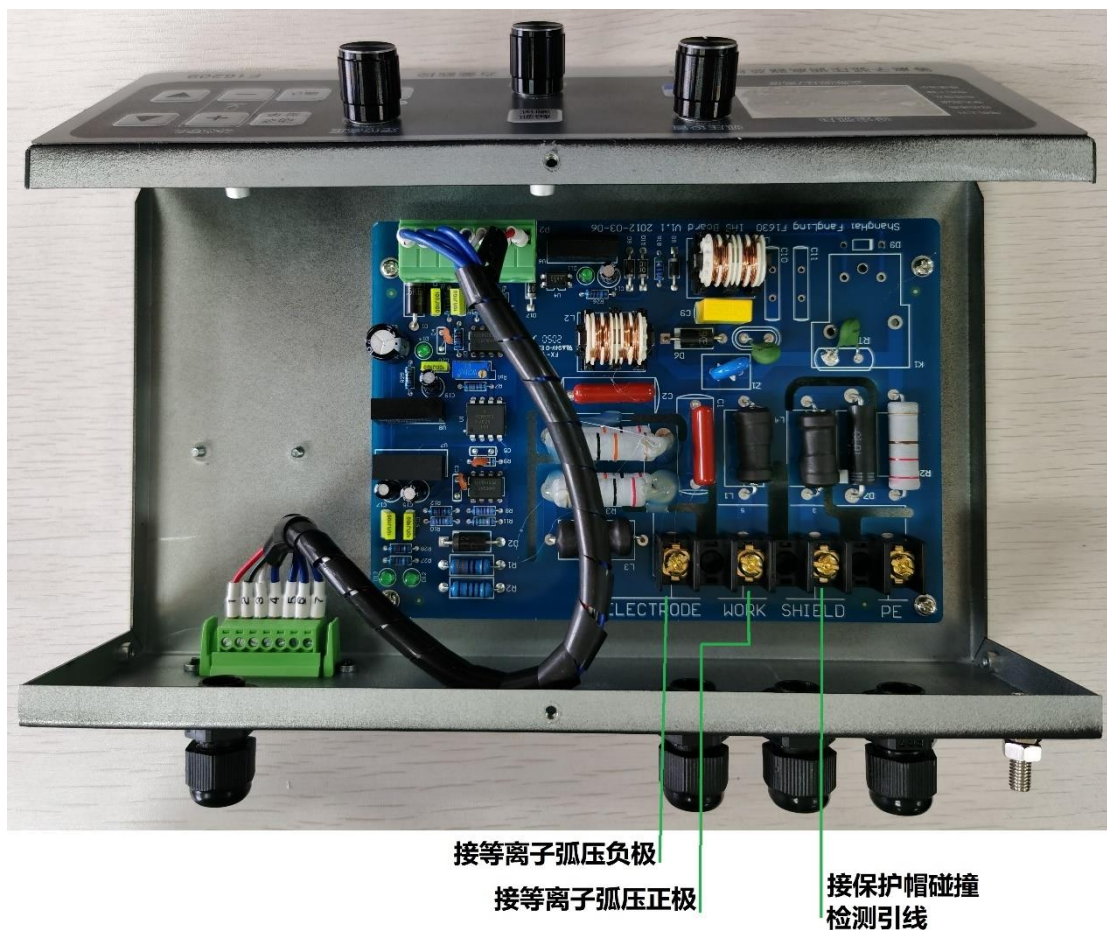
图 2.7 F16209 总线控制台内部分压板接线
