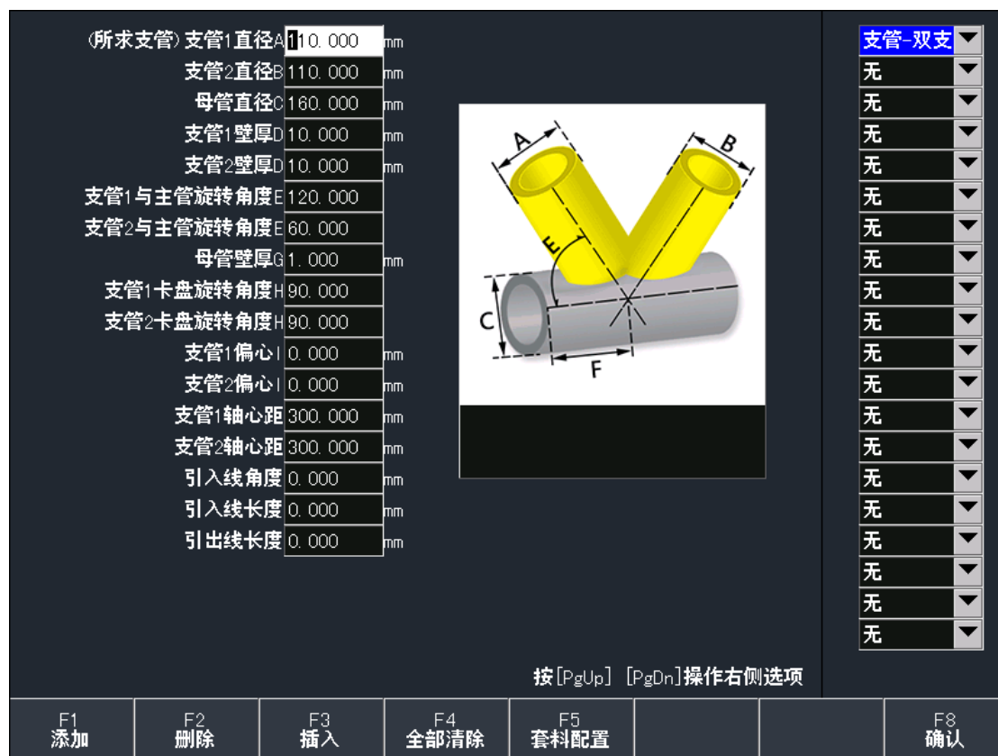
图 9.13 支管-双支管参数界面
