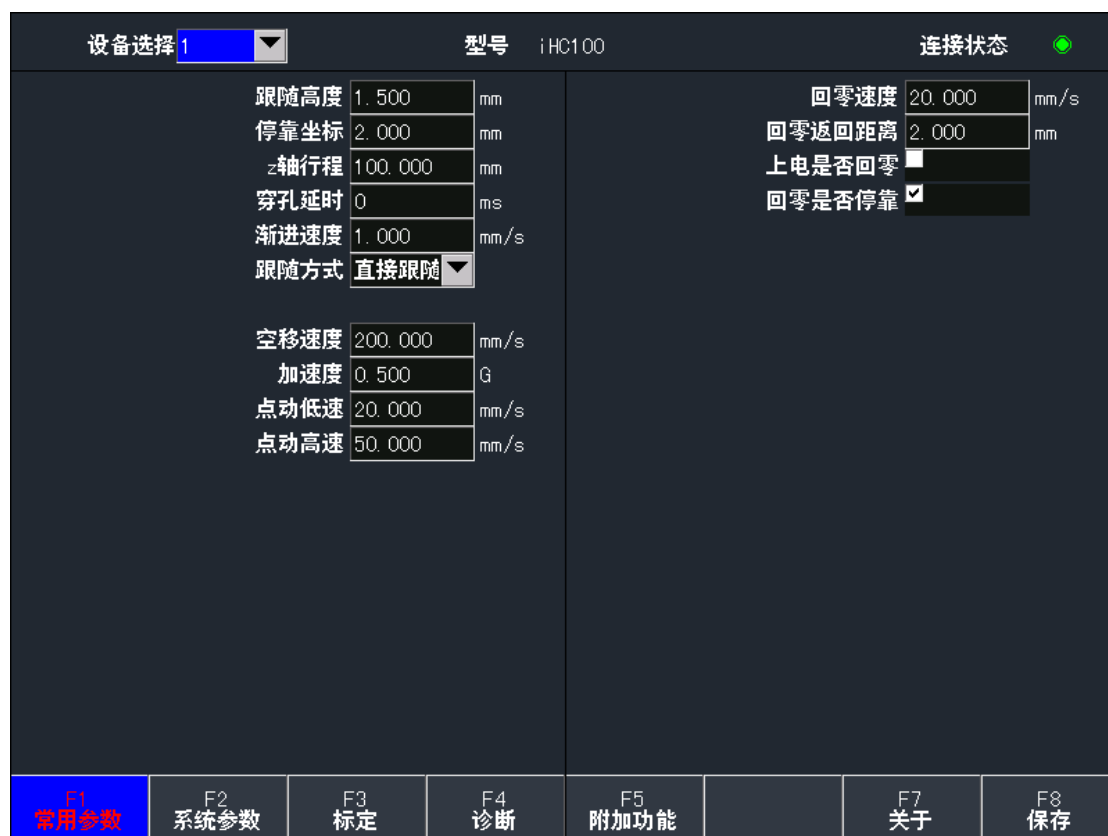
图 7.5 激光调高器常用参数
