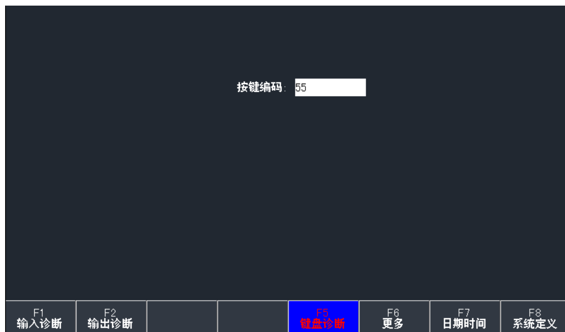
图 8.4 键盘诊断界面
