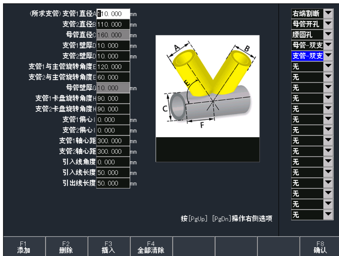
图 9.18 支管-双支管参数界面
