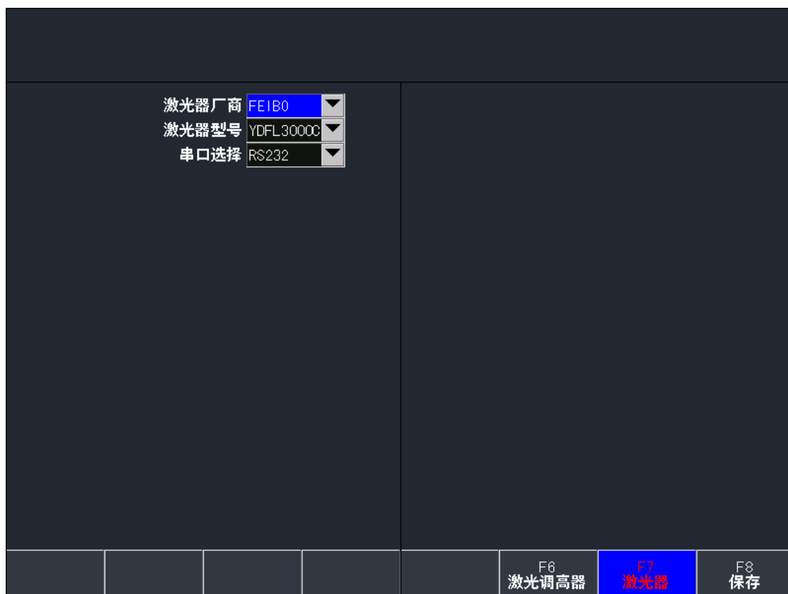
图 13.10 设置飞博激光器串口通信
