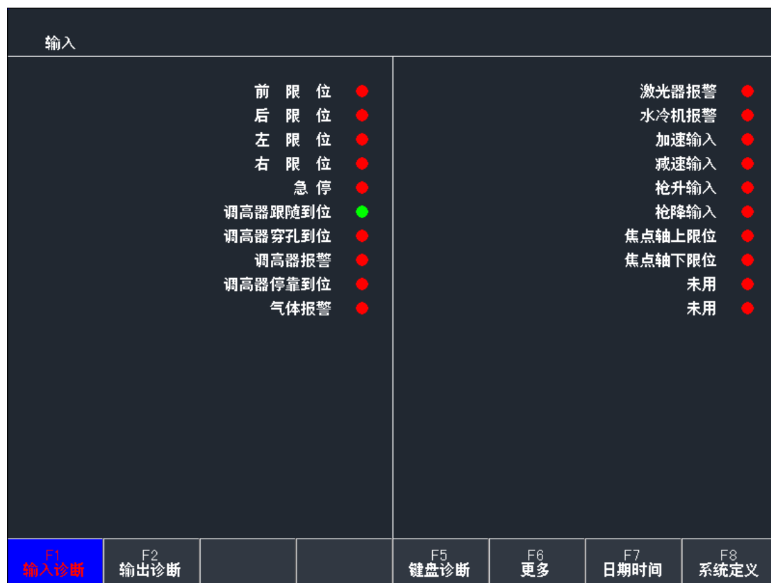
图 8.2 系统诊断界面（输入诊断）
