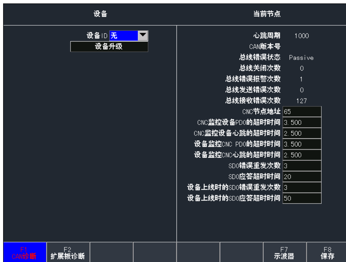
图 8.5 CAN 设备诊断界面
