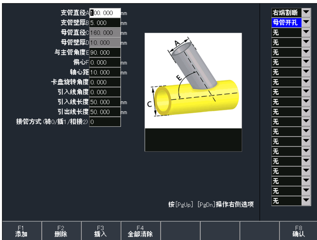
图 9.13 母管开孔参数界面
