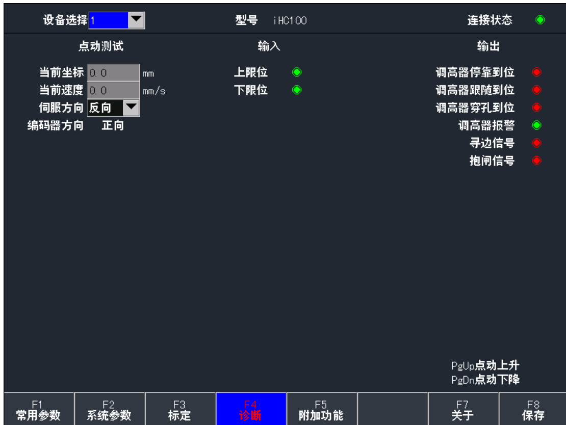
图 7.9 激光调高器诊断
