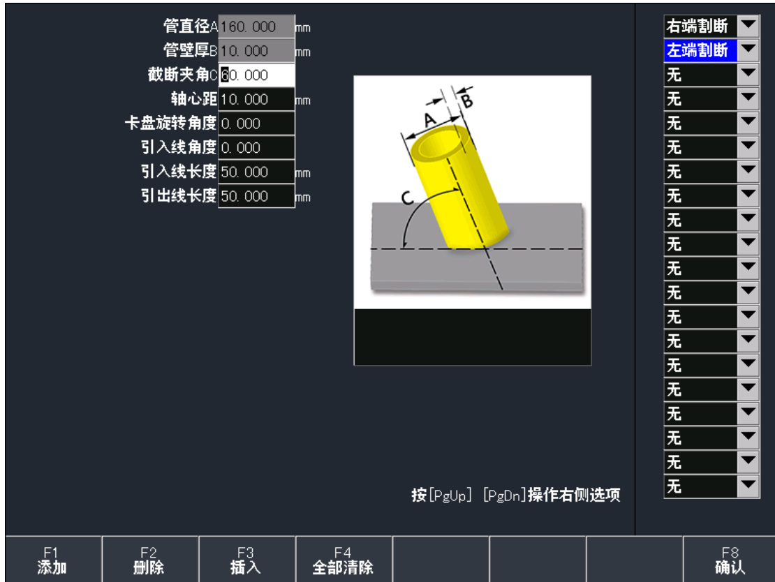
图 9.10 左端割断参数界面
