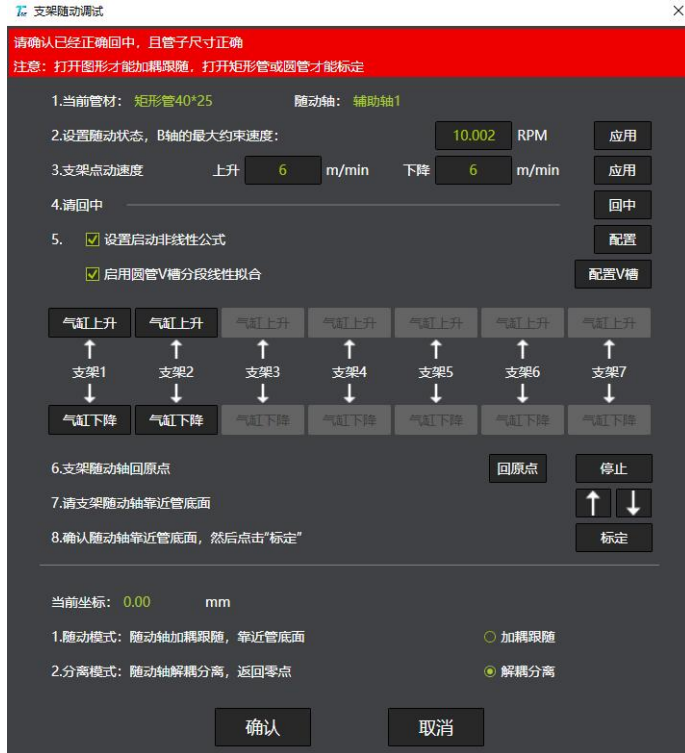
图 3.39 支架随动调试
