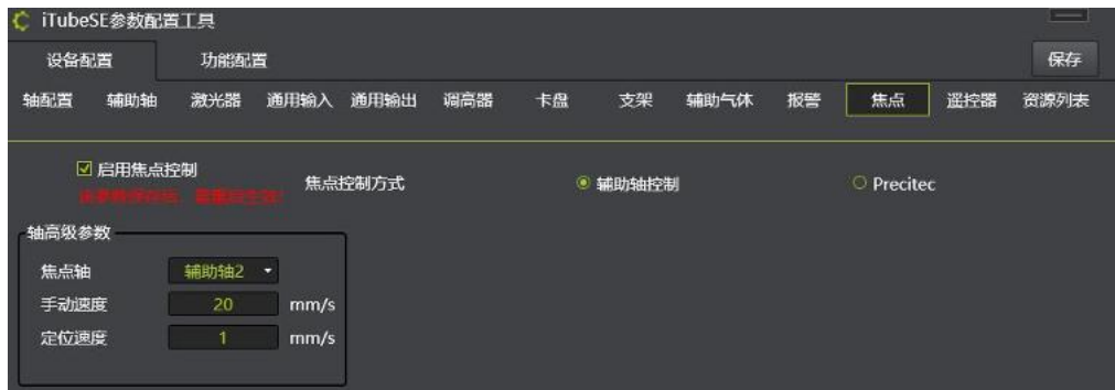
图 4.17 辅助轴控制方式
