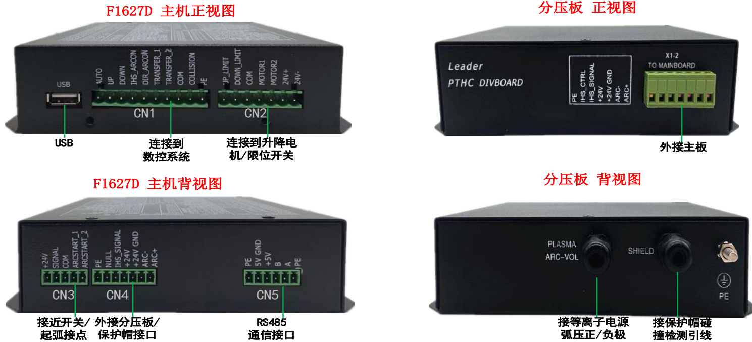
图 3.9 F1627D 机箱及分压板视图
