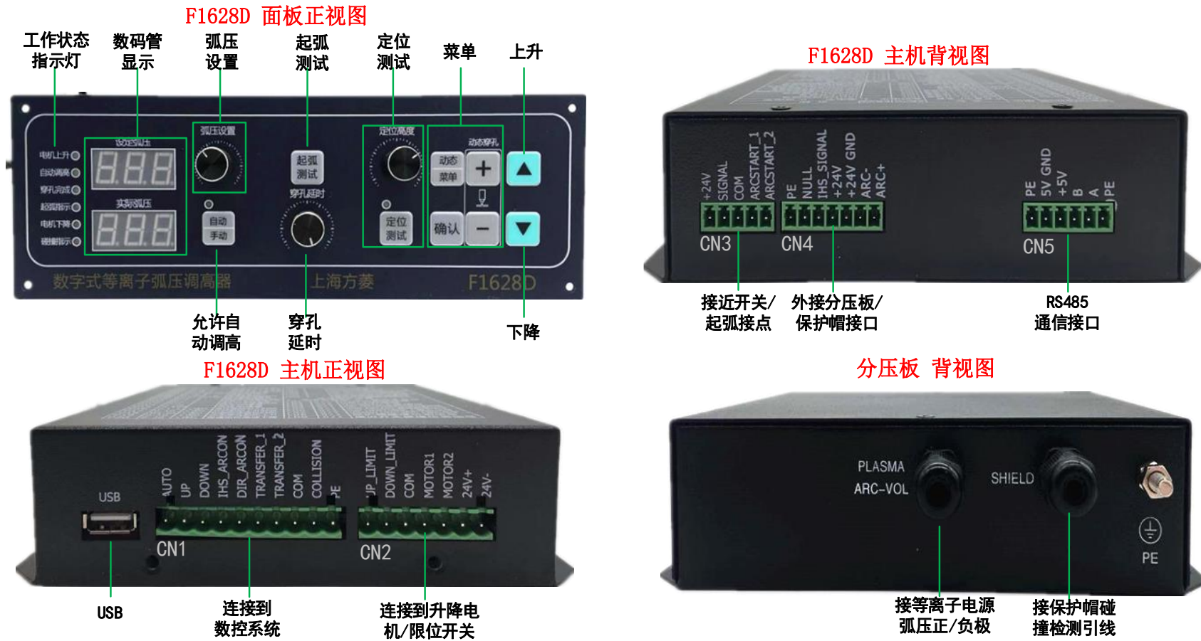
图 3.11 F1628D 机箱及分压板视图
